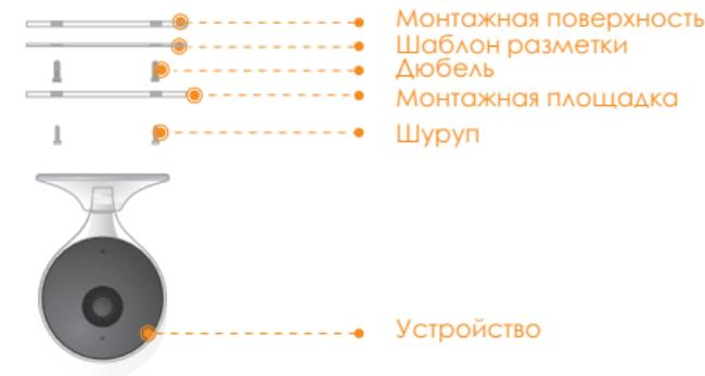
**Шаг 1** Просверлите отверстия для винтов на монтажной пластине согласно схеме монтажа и вставьте дюбели.
